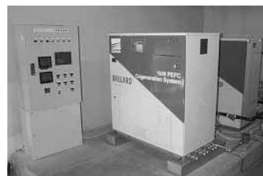
家庭用燃料電池 1kW 級の実験機
